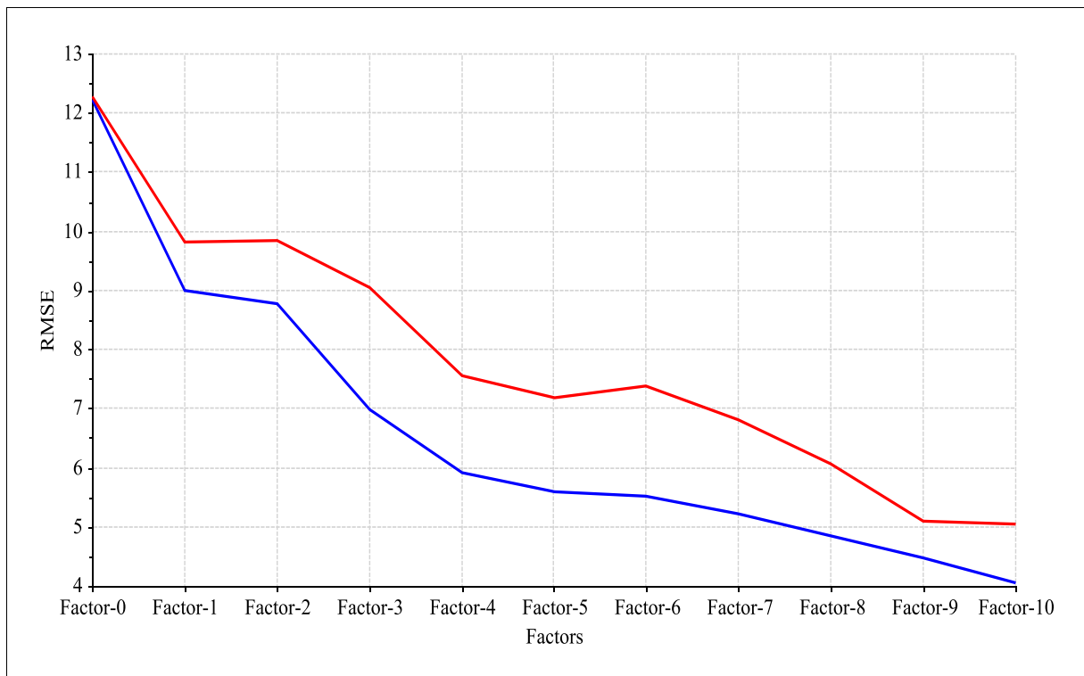
Abbildung 31: Kalibrierungs- und Validierungslinien im RMSE-Faktoren-Plot zur Faktorisierung der NM-NIR-Methode zur Bestimmung von Partikelgrößen.
